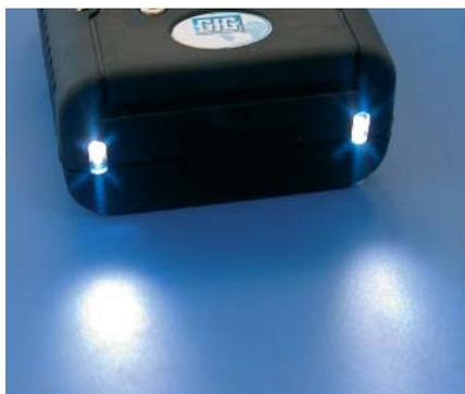
rechtzeitig vor Eintauchen des Gerätes erkannt. Die vorhandene Akku- oder Batterieeinheit kann bei Bedarf gegen das Akkumodul mit integrierter Lampe ausgetauscht werden. Somit ist eine problemlose Nachrüstung gewährleistet.
