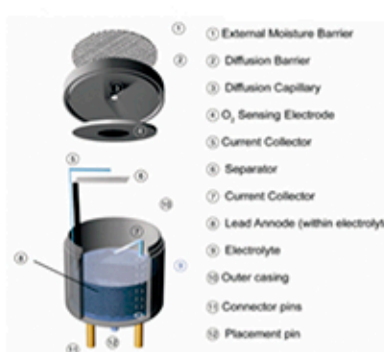
Figura 3: Partes de sensor electroquímico que permite a través de la circulación de la corriente la cual es proporcional a la concentración de gas a detectar. Sensor para la detección de oxígeno. GfG Instrumentation de USA.
