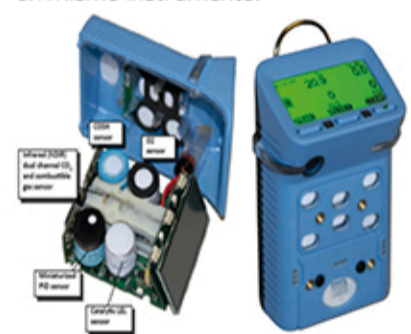
Figura 6: a) Derecha: Detector multi-gases G460 b) Izquierda: Detector multi-gases G460 mostrando los sensores de O 2 , CO, SO 2 , H 2 S, %LEL, PID. GfG Instrumentation de USA.
