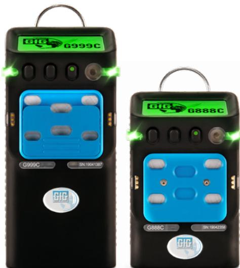
Personenbezogene Gaswarngeräte nutzen das Prinzip der Diffusion. Die Moleküle des zu messenden Gases oder Dampfs diffundieren passiv in den Sensor. Für eine möglichst genaue Messung ist es erforderlich, dass die Person das Gerät in ihrem Atemwegsbereich trägt. Die Messwerte sollten aus derselben Luft stammen, die auch in die Lunge der Person gelangt, die das Messgerät bei sich führt.
