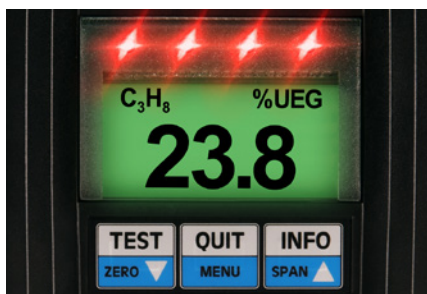
CC28 DA avec affichage, voyants d'alarme et buzzer
